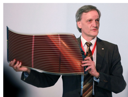
Ein kommerziell erhältliches flexibles Modul einer polymeren organischen Solarzelle.
